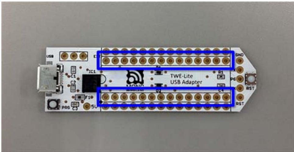
前述の使用例 C で使用する場合は以下の部分に 5P ピンヘッドをハンダ付けしてください。
