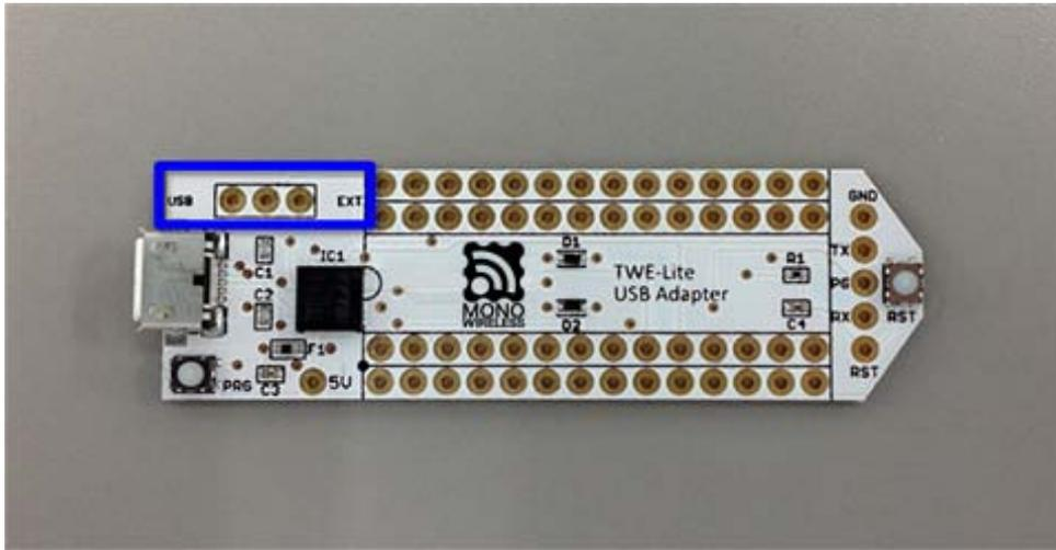
前述の使用例 B で使用する場合は以下の部分 2カ所に 14P ピンヘッドをハンダ付けしてください。
