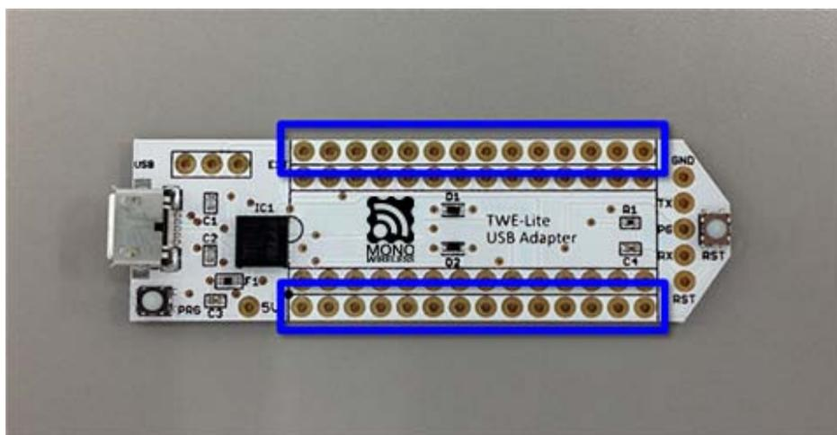
以下の部分に用途に応じてスイッチかジャンパをハンダ付けしてください。
