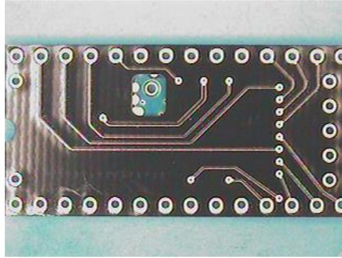
モジュール側より、ワイヤアンテナを差し込む 実装基板裏面より、半田付け
